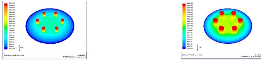
a)  $R_3 = 1.5\text{mm}$  时轴承的压力分布云图
